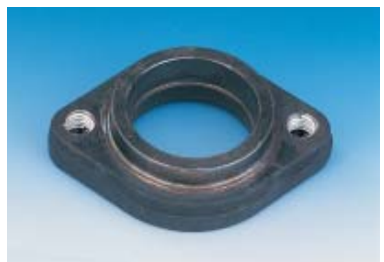
Matice pro použití do vysokých teplot s vložkou HELICOIL® z INCONEL – postříbřená a matice s HELICOIL®plus SCREWLOCK® jako zabezpečení proti ztrátě.
